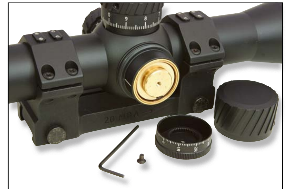
Nullen der Seiteneinstellung, bewährte Technik, aber die kleine Schraube muss dazu gelöst werden. Man kann nicht einfach durch Anheben der Drehscheibe die Einstellung nullen.
