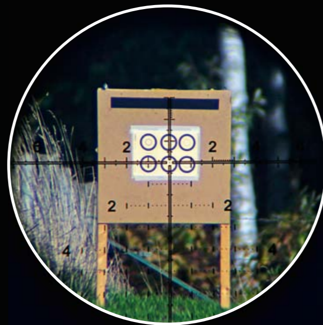
Die maximale Vergrößerung des 5-25x56 auf 100 Meter Entfernung. Die Auflösung ist sehr gut, denn das Raster, das aus 0,2 mm Linien besteht, ist gut erkennbar.
