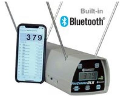
Die ProChrono DLX funktioniert nach dem Prinzip der Zeitmessung für den Weg, den ein Projektil vom ersten Sensorelement zum zweiten Sensorelement zurücklegt. Die intern im Gehäuse montierten Sensoren überwachen Licht durch die beiden rechteckigen Öffnungen oben am Gehäuse. Diese speziell entwickelten elektromechanischen Sensoren können die geringen Änderungen in der Lichtintensität erkennen, die auftreten, wenn ein Projektil Lichtstrahlen unterbricht.
